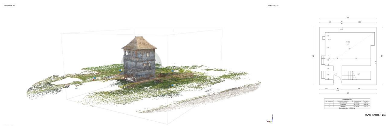
Figura nr. 2. Generarea țesăturii 3D a culei Cioabă-Chințescu cu ajutorul Agisoft și Relevul culei.
